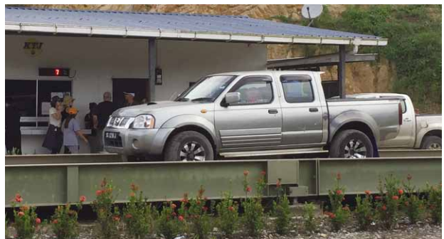
昨年開設されたKemajuan Tanah Jujurコレクションセンター。まず車ごと重量を測り、その後荷台のアブラヤシ(果房)をおろし、再び車を計量、その差にその日のレートで一定の搾油量の割合で換算し、買い取られる。センターは今まで個別にミルに売られていたアブラヤシをまとめて搾油所に輸送する。残念なことに、このセンターはまだRSPO認証が取れていないので、認証油としては流通できない。
