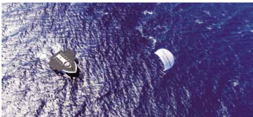
R4W のボート。風により風を利用した推進力と太陽光パネルの電力で海水を真水にし水素をつくり、海上だけでつくったエネルギーを利用して世界を航海している。
