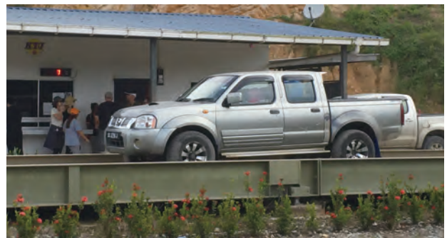
Kemajuan Tanah Jujurコレクションセンター。まず車ごと重量を測り、その後荷台のアブラヤシ(果房)をおろし、再び車を計量、その差に当日のレートで、一定の搾油量の割合で換算し、買い取られる。センターは今まで個別にミルに売られていたアブラヤシをまとめて搾油所に輸送する。残念なことに、このセンターはまだRSPO認証が取れていないので、認証油としては流通できない。
